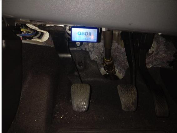
Imagens, resultado da conexão Scanner OBDII com Aplicativo:
