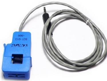
Transformador de corrente não-invasivo. Normalmente utilizado para construção de monitores de energia pessoais. Adequado para o monitoramento de medição de corrente, proteção de motor CA, equipamentos de iluminação, compressor de ar e outros.
