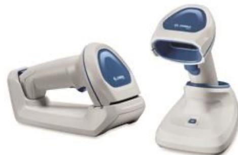
Feitos de materiais antibacterianos e que podem ser esterilizados. Atendem aos impedimentos de expor medicamentos à sinais de radiofrequência.
